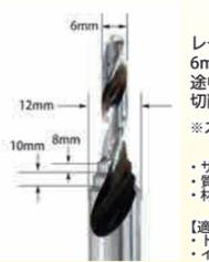
レースウェイの幅寸法に合わせた形状で先端部分6mmから最大12mmへ遷移します。途中に8mm、10mmの段付き形状を設け、切削性能を向上させています。
