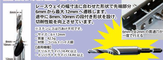
レースウェイの幅寸法に合わせた形状で先端部分、6mmから最大12mmへ遷移します。途中に8mm、10mmの段付き形状を設け、切削性能を向上させています。
